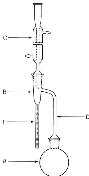
**Figura 1** - Aparato para a determinação de água por destilação azeotrópica.
