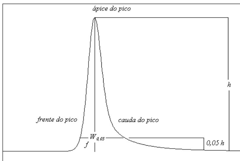
**Figura 3** – Cromatograma representando a assimetria do pico.
