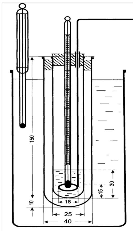
**Figura 1** - Aparelho para determinação do ponto de congelamento.
