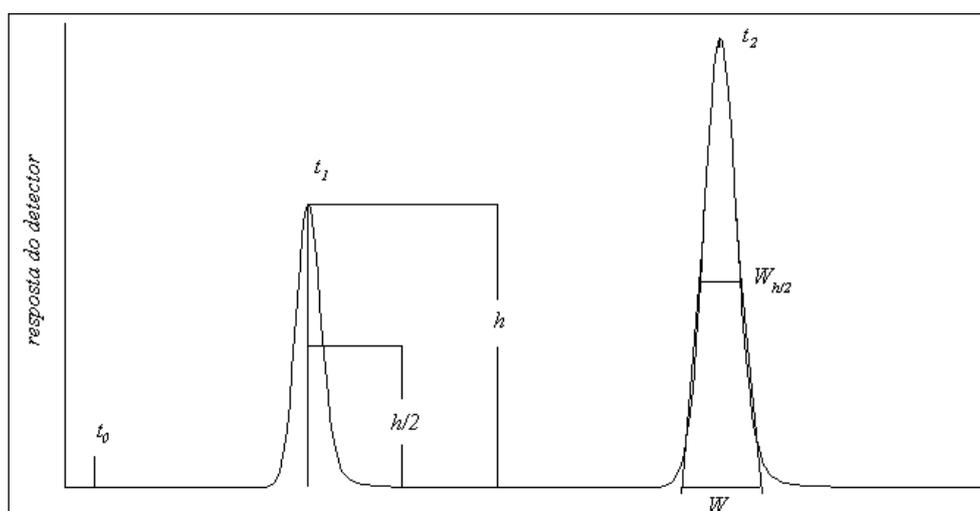
**Figura 1** – Separação cromatográfica de duas substâncias.
