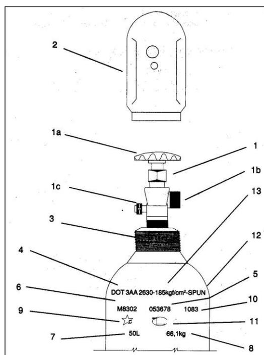
**Figura 1 - Dados constantes do cilindro e da válvula.**
