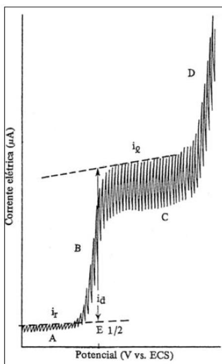
**Figura 1-** Polarograma de espécie eletrorredutível.
