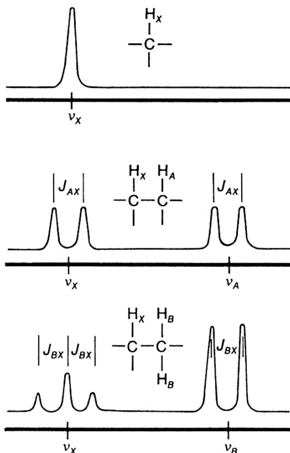
**Figura 3** – Exemplo de acoplamento de primeira ordem.
