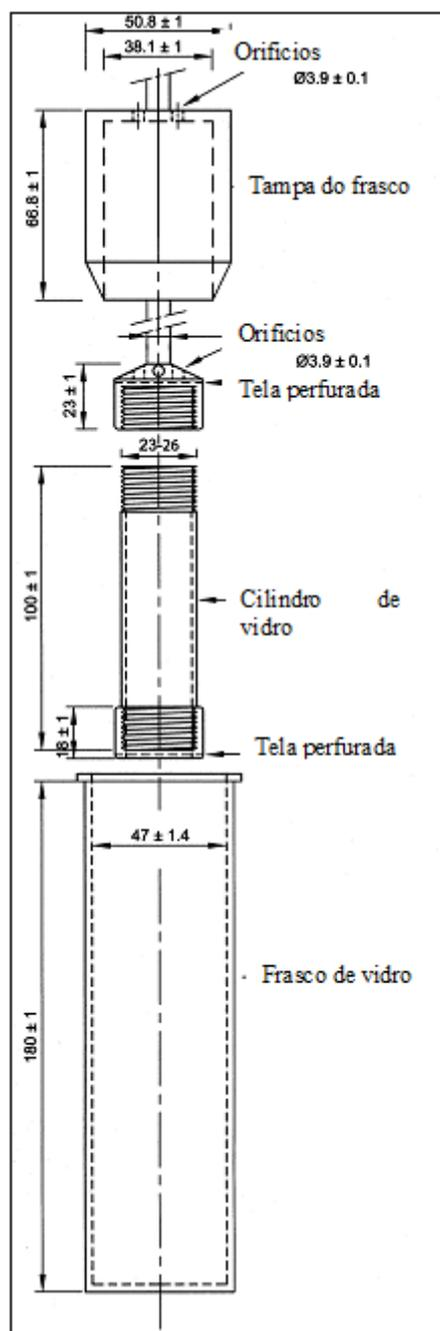
**Figura 3** – Método 3 (Cilindros alternantes).
