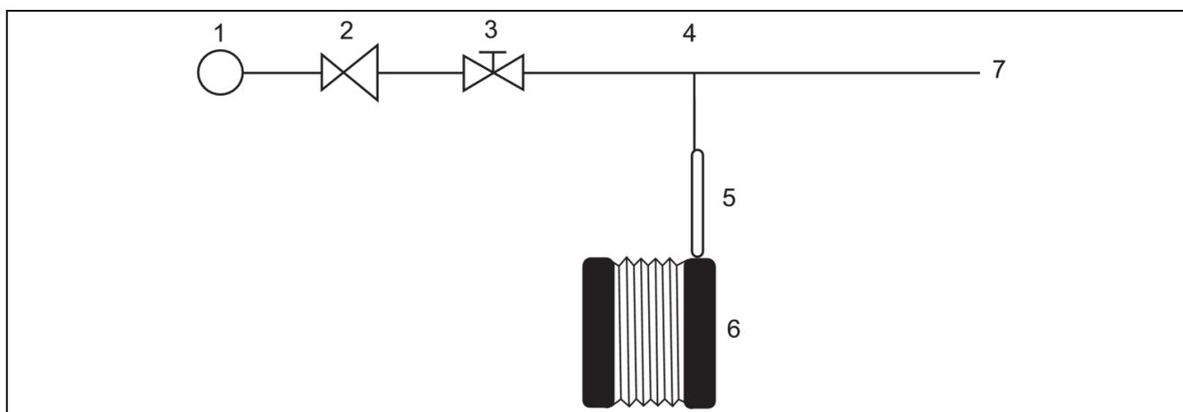
**Figura 1** – Montagem para tubos detectores de gases.
