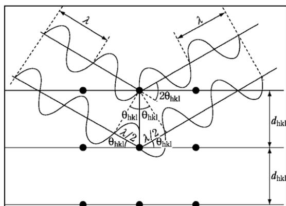
**Figura 1b** - Difração de raios X por um cristal de acordo com a lei de Bragg.
