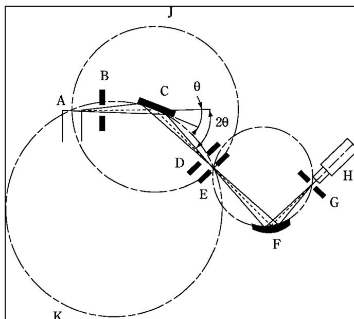
**Figura 3** - Arranjo geométrico da geometria parafocal de Bragg-Brentano.
