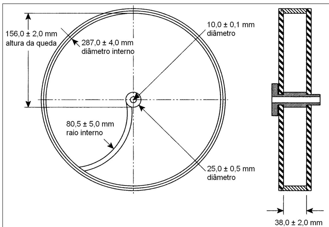
**Figura 1 – Aparelho para teste de friabilidade (friabilômetro).**
