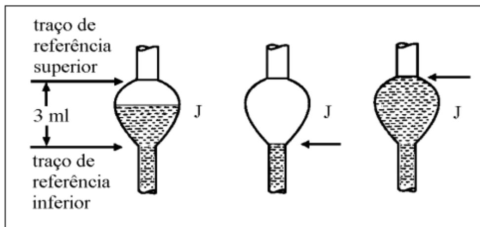
**Figura 2** - Indicação para determinação da velocidade de destilação.
