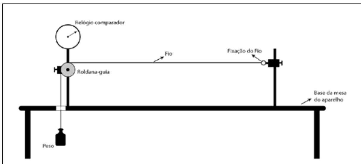
Figura 1 – Modelo de mesa sugerida para a medição de diâmetro de suturas multifilamentares.
