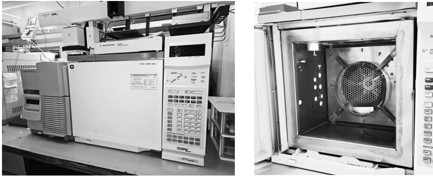
Figura 12 – (A) Equipamento de cromatografia com fase gasosa acoplado a espectrômetro de massa; (B) coluna capilar instalada no forno do cromatógrafo
