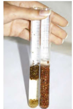
Material entumescido no tubo da direita
